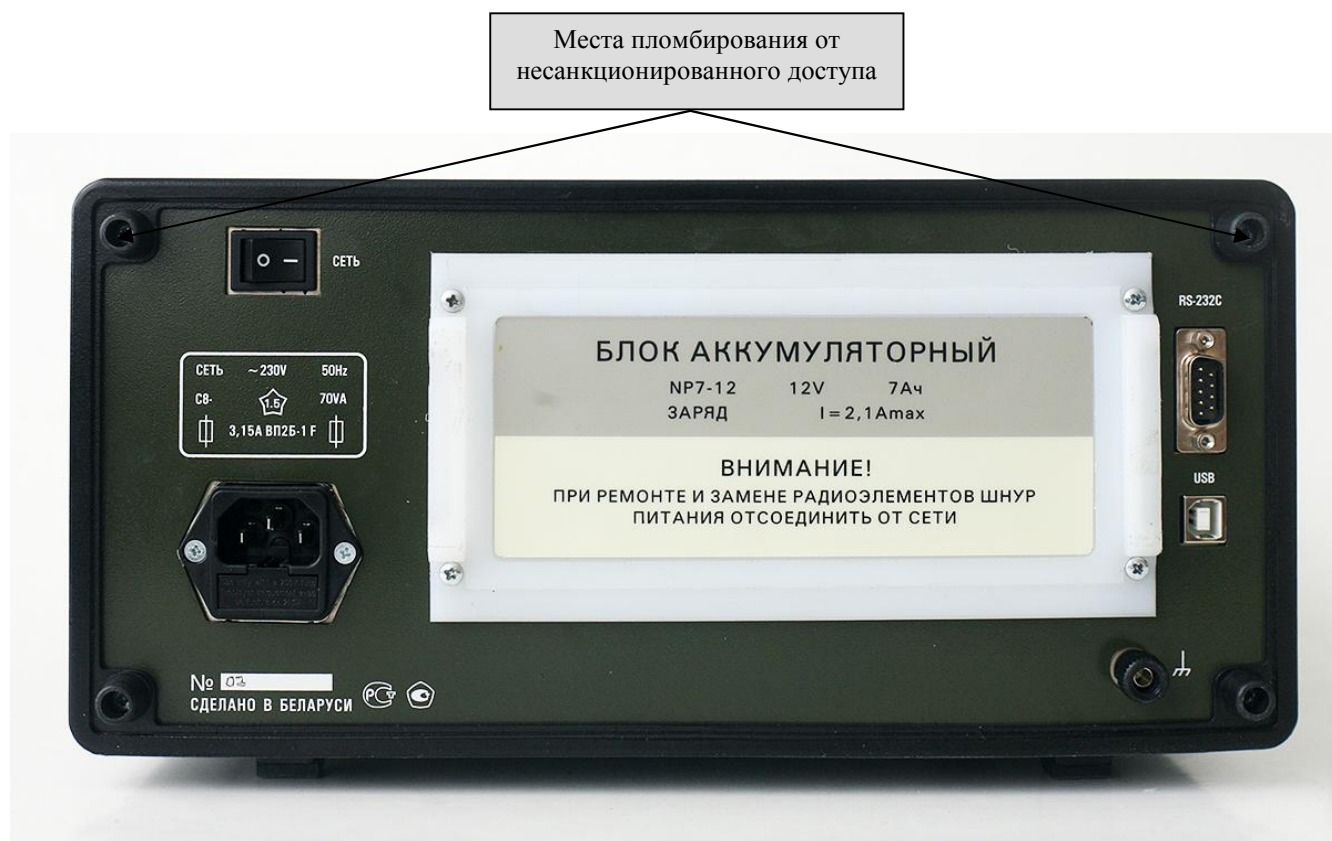
Рисунок 2 - Задняя панель осциллографа с указанием мест пломбирования
