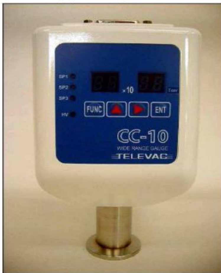
Рис. 2 Общий вид вакуумметра электронного со встроенным дисплеем СС-10
