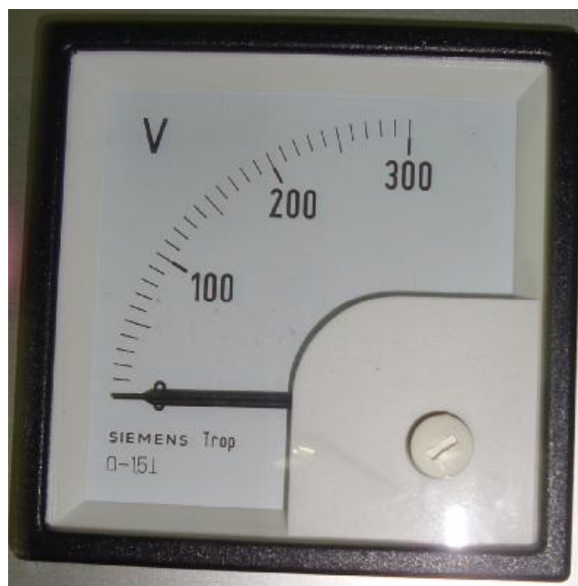
Рисунок 2 – Вольтметр щитовой SQ 72 DS Напряжение постоянного тока
