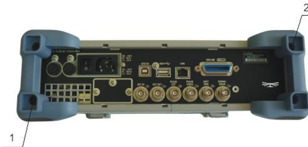
Рисунок 2 – Схема пломбирования от несанкционированного доступа с нанесением знака поверки
