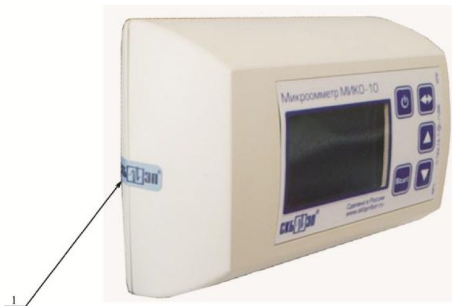
Рис. 2. Схема пломбировки от несанкционированного доступа 1 – место нанесения саморазрушающейся наклейки
