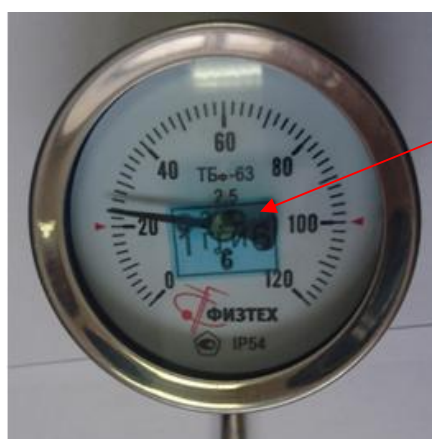
Рисунок 5 – Место нанесения знака поверки на стекло
