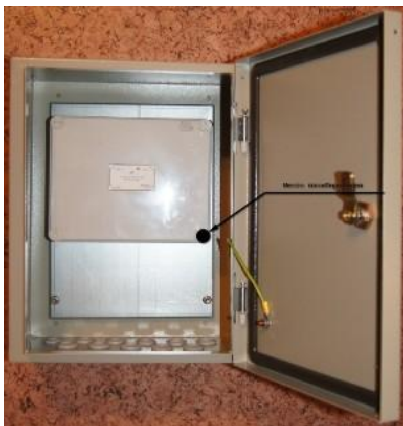
Рисунок 2 - Внешний вид системы АСКТ-У и место нанесения пломбы
