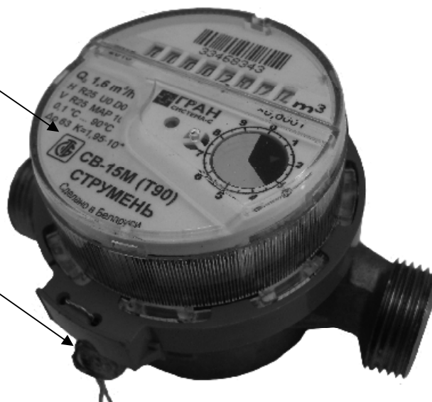
Рисунок 1 - Внешний вид, место пломбирования крыльчатых счетчиков воды «СТРУМЕНЬ»
