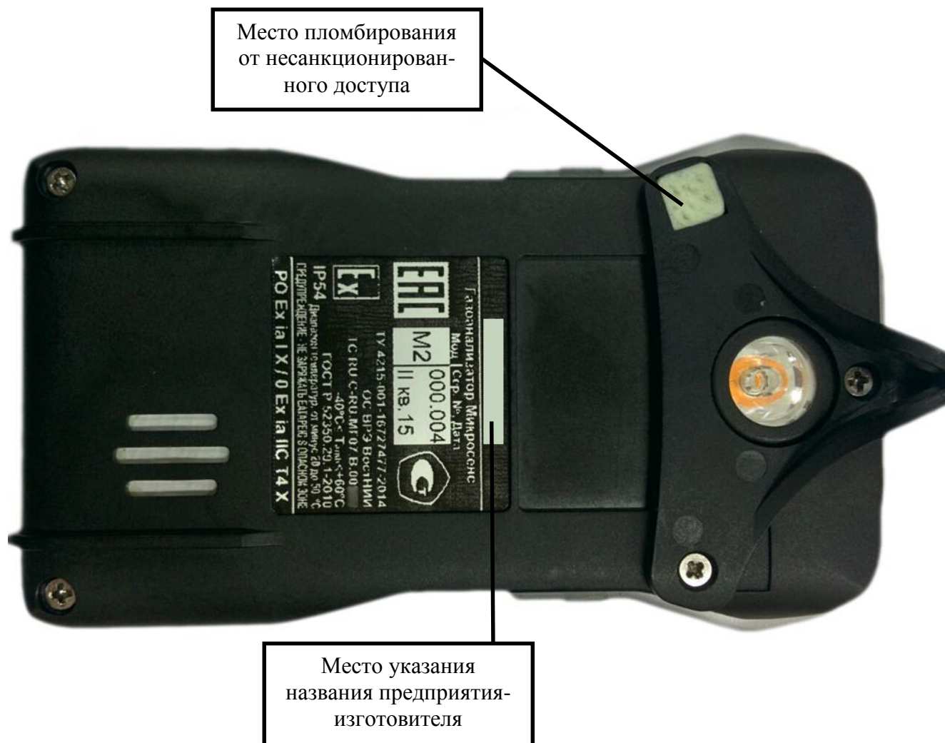
Рисунок 2 - Схема пломбировки от несанкционированного доступа
