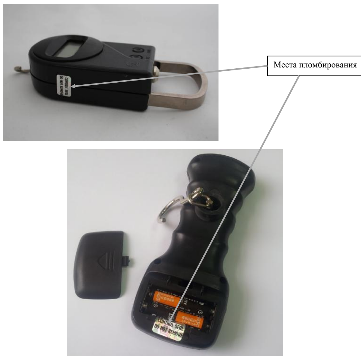
Рисунок 3 - Схема пломбирования электронного блока от несанкционированного доступа
