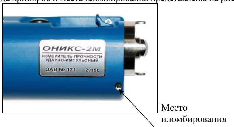
Рисунок 1 - Место пломбирования и клеймения приборов модификации Оникс-2М
