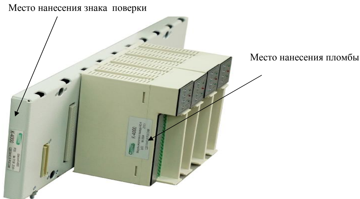
Рисунок 2 - Места нанесения пломбы и знака поверки
