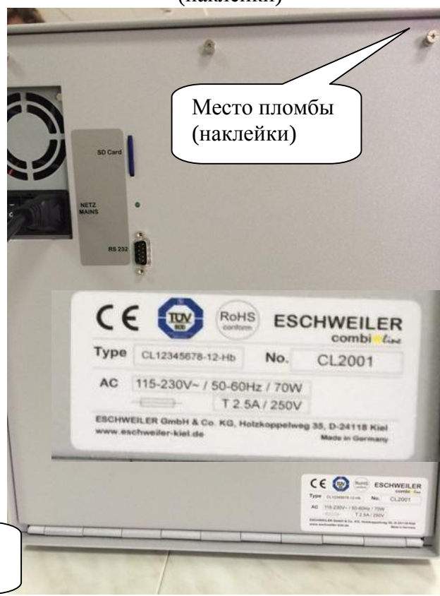
Рисунок 4 - Анализатор ESCHWEILER модели COMBI line. Расположение пломбы (наклейки)
