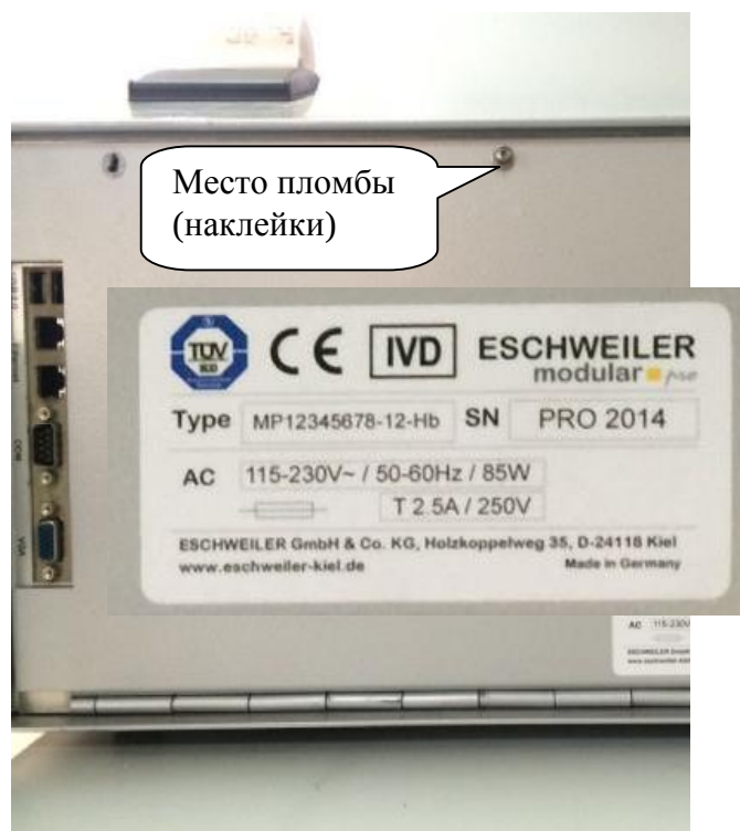
Рисунок 2 - Анализатор ESCHWEILER модели MODULAR pro. Расположение пломбы (наклейки)
