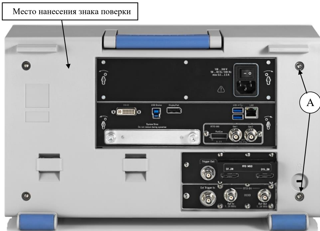
Рисунок 2 - Схема пломбировки от несанкционированного доступа (А), место нанесения знака поверки
