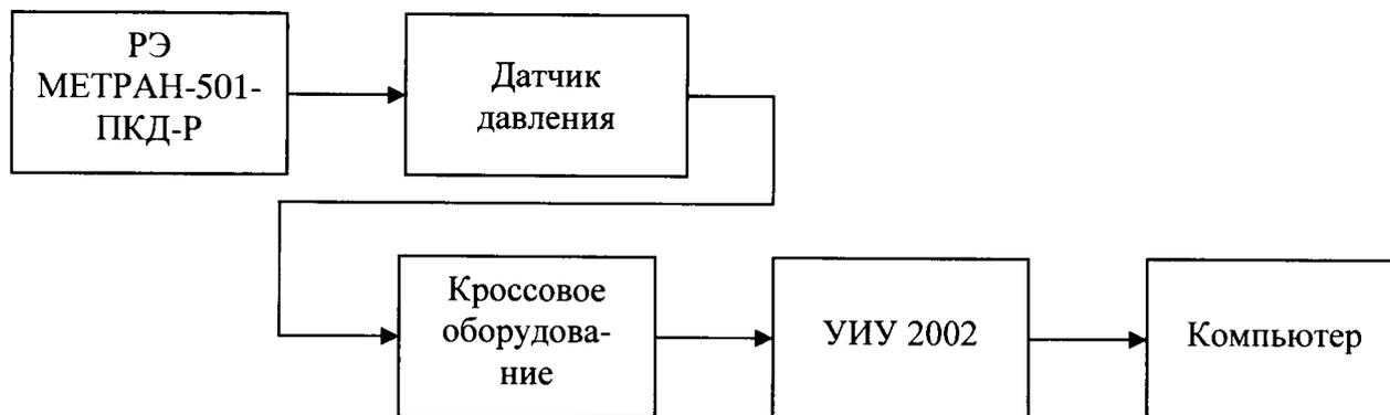
Рисунок 1 - Блок-схема комплектной поверки ИК давления
