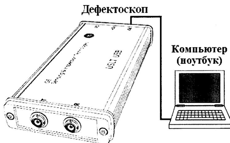
Рисунок 1 – Подключение электронного блока дефектоскопа к компьютеру
