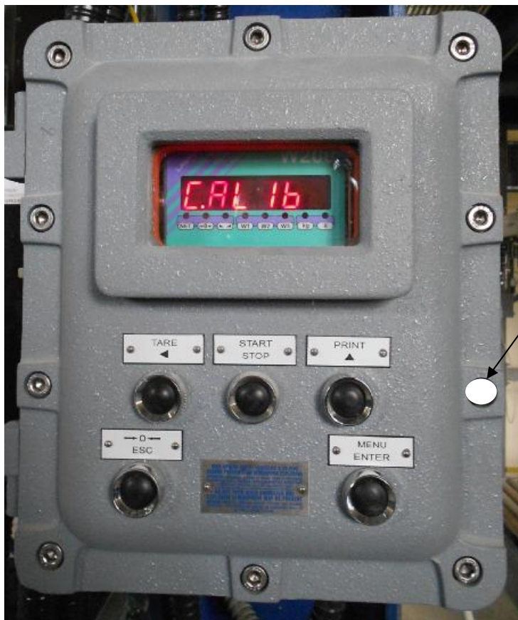
Рисунок 2 – Схема пломбировки весов неавтоматического действия SPIROFLOW II
