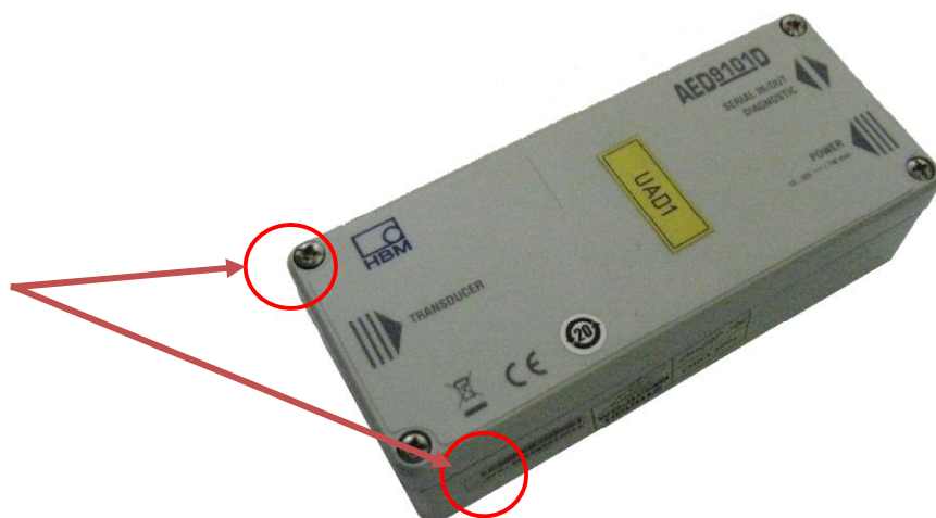
Рисунок 7 - Место пломбирования переключателя юстировки устройства обработки аналоговых данных AD103C (наносится разрушаемая наклейка на скрытый свитч-переключатель преобразователя AD103C)
