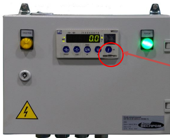
Рисунок 6 - Место пломбирования прибора WE2111, встроенного в ШИ (наносится разрушаемая наклейка справа от вспомогательной клавиатуры)
