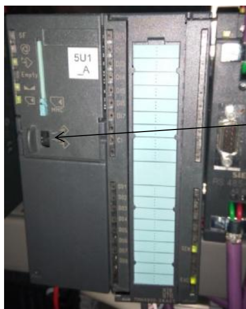
Рисунок 3 - Схема пломбирования модуля многофункционального SIWAREX FTA и место нанесения знака поверки
