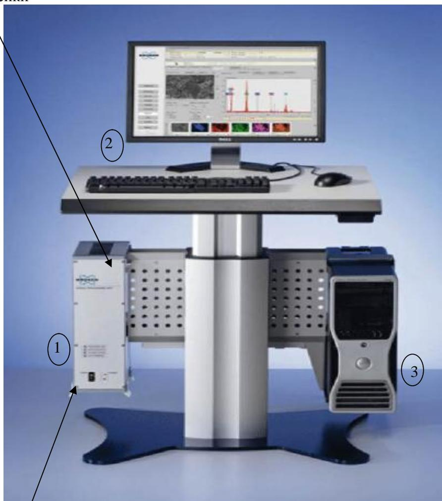
Рисунок 1 – Общий вид системы Quantax EDS без детектора
