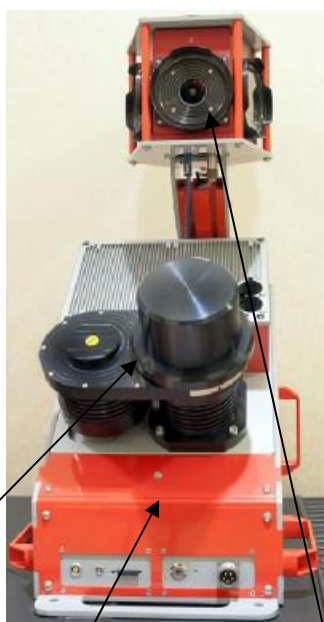
а - сканер б - система инерциальной навигации в - камера
