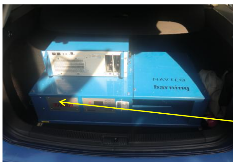
Рисунок 2 - Блок управления, установленный в багажном отделении автомобиля
