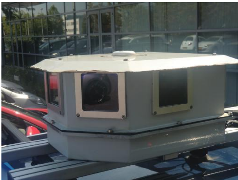
Рисунок 1 - Блок первичных датчиков, установленный на крыше автомобиля
