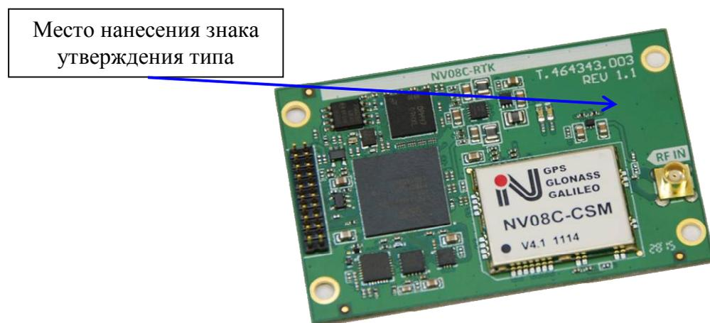
Рисунок 1 - Внешний вид аппаратуры геодезической спутниковой NV08C-RTK
