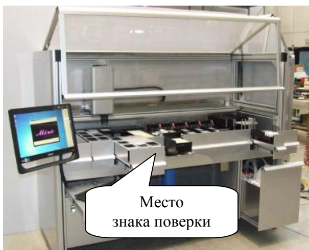
Рисунок 13 - Анализатор автоматический для иммуноферментного анализа, модель IMAXYZ-15. Вид спереди
