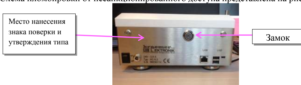
Рисунок 5 - Схема пломбировки от несанкционированного доступа
