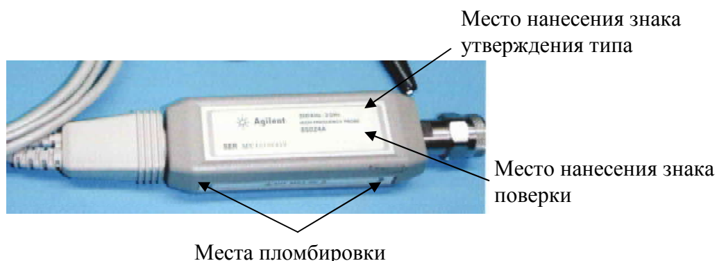
Рисунок 2 - Внешний вид пробника с указанием мест пломбировки и нанесения знака утверждения типа и знака поверки
