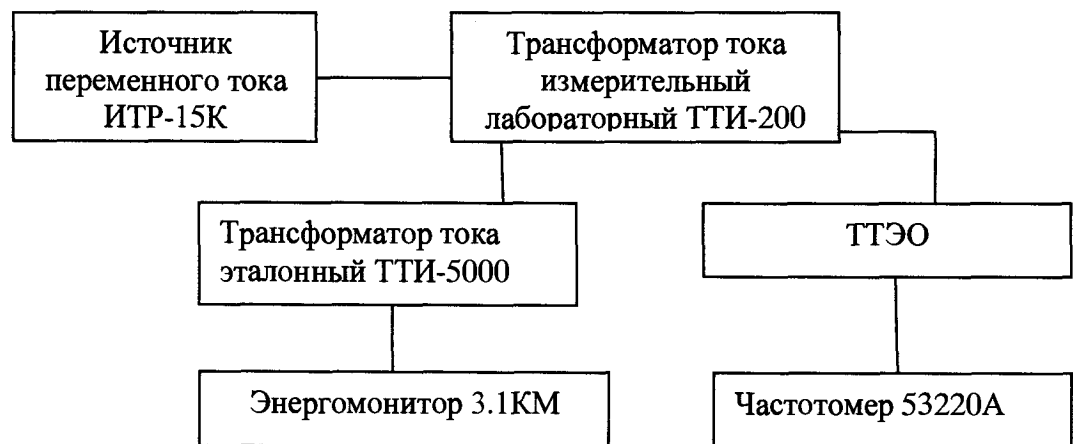
Рисунок 5. Схема для определения погрешности коэффициента преобразования силы переменного и постоянного тока
