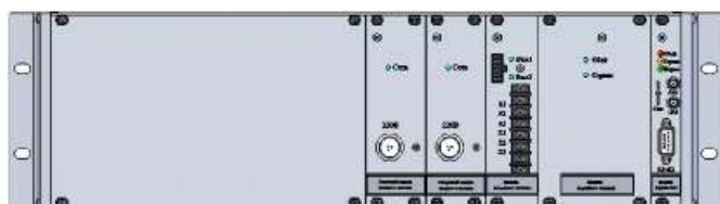
Рисунок 8 - Электронный блок резервированного блока питания повышенной надежности (вид сзади)
