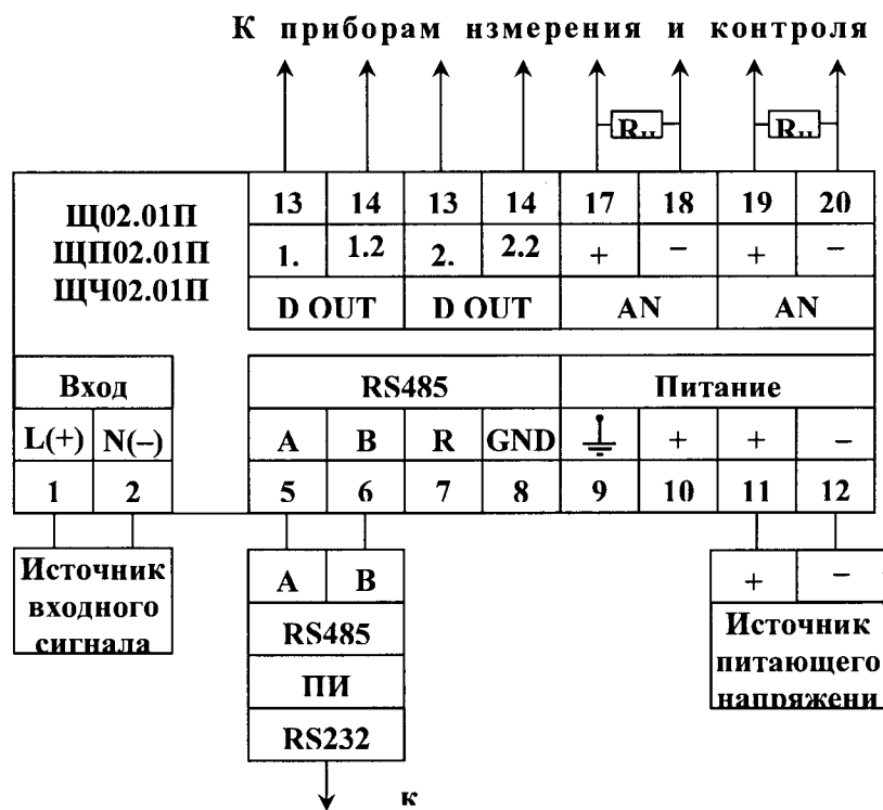
Рисунок А.3 – Схема подключения приборов Щ02.01П, ЩП02.01П, ЩЧ02.01П
