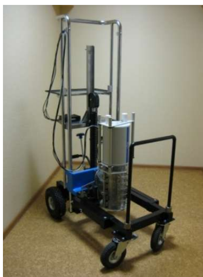
Рисунок 8 - Внешний вид тележки с комплексом для вариантов исполнения Эко ПАК-01-1, Эко ПАК-02-1, Эко ПАК-03-1
