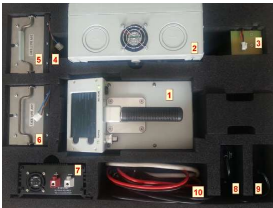
Рисунок 2 - Внешний вид переносного БД для вариантов исполнения Эко ПАК-01-2, Эко ПАК-02-2, Эко ПАК-03-2
