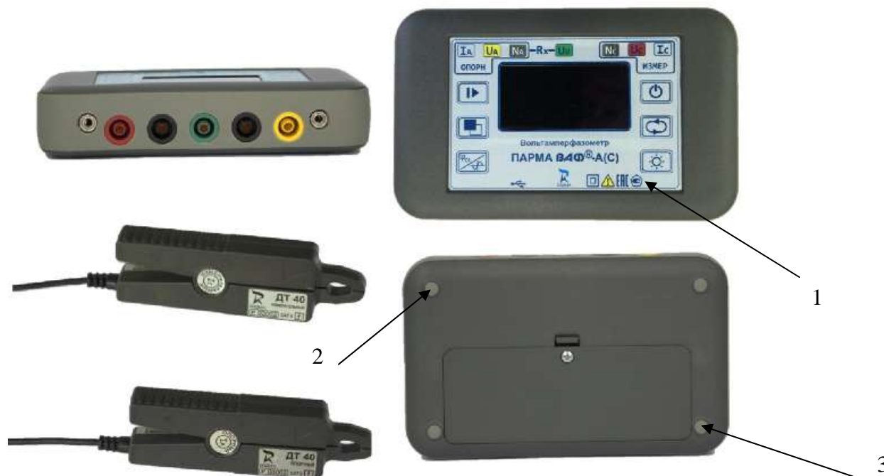
Рисунок 1 – Внешний вид вольтамперфазометра «ПАРМА ВАΦ ® -А(С)» с принадлежностями. 1 - знак утверждения типа, 2 – место опломбирования, 3 – место знака поверки.
