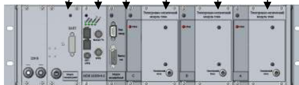
Рисунок 9 – Электронный блок трансформаторов ТТЭО (вид сзади) и схема пломбировки от несанкционированного доступа
