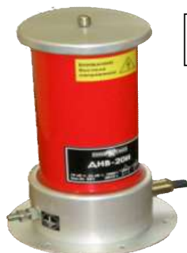
Рисунок 1 – Фотография общего вида первичного измерительного преобразователя (делитель напряжения)
