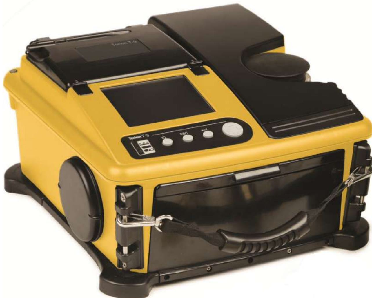
Рисунок 2 - Внешний вид хроматографов газовых портативных модели Torigon T-9 с масс-спектрометрическими детекторами
