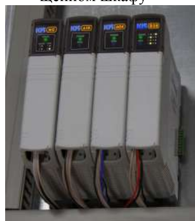
Рисунок 4 – Функциональные модули контроллера
