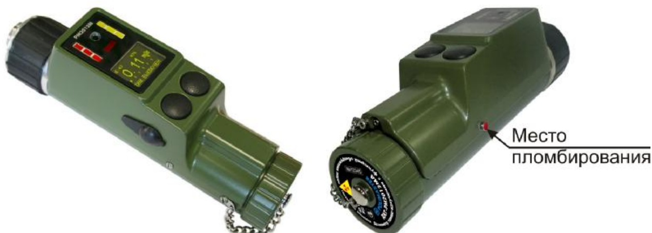
Рисунок 1 - Общий вид дозиметров гамма - излучения ДКГ-РМ2012М Знак поверки наносится на эксплуатационную документацию
