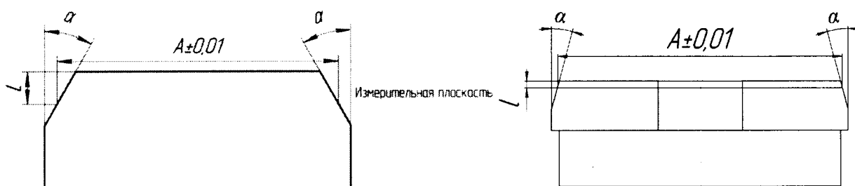
а) Шаблон настроечный с размером А менее 185 мм б) Шаблон настроечный с размером А более 185 мм Рисунок 9 – Общий вид шаблонов настроечных Ш-НИИК-100/15.10.000 для прибора НИИК-100/15
