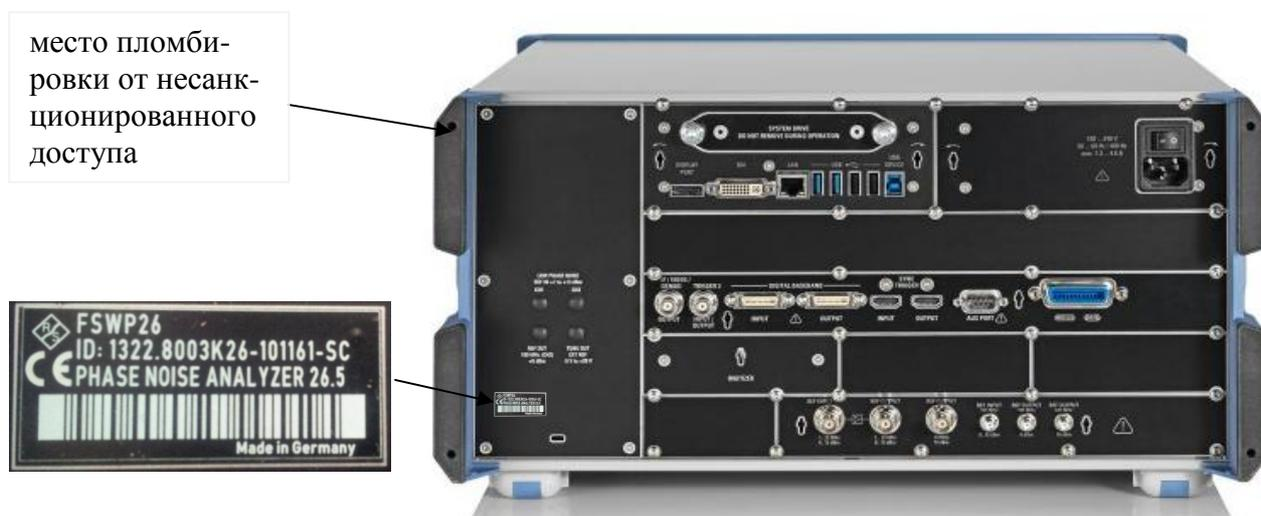
Рисунок 2 - Схема пломбировки от несанкционированного доступа и размещения наклейки
