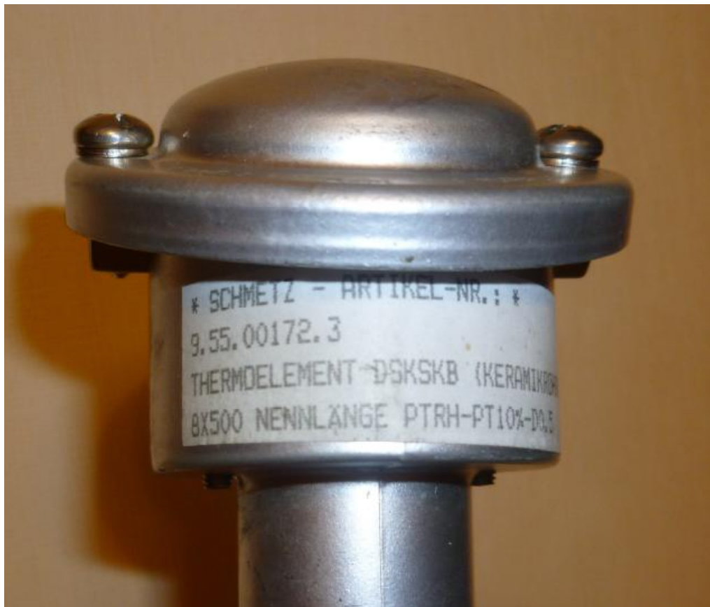
Рисунок 2 – Заводские номера и маркировка преобразователя термоэлектрического 9.55.00172.3
