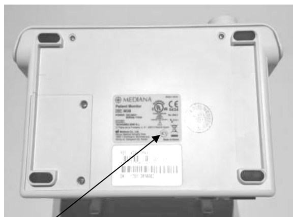
Место нанесения знака утверждения типа Рисунок 2 – Схема маркировки монитора пациента LUCON, вариант исполнения M20
