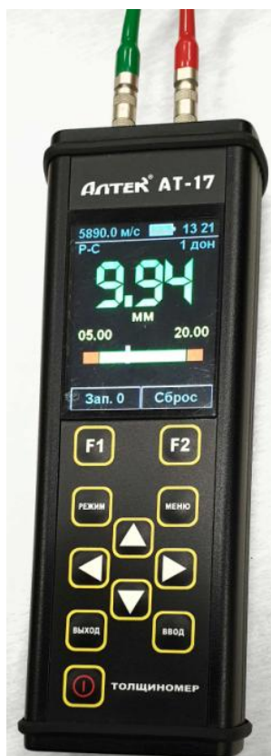
Рисунок 1 - Общий вид электронного блока толщиномеров
