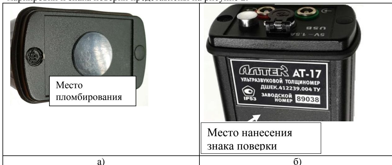
Рисунок 2 - а) схема пломбировки от несанкционированного доступа б) обозначение места маркировки и знака поверки
