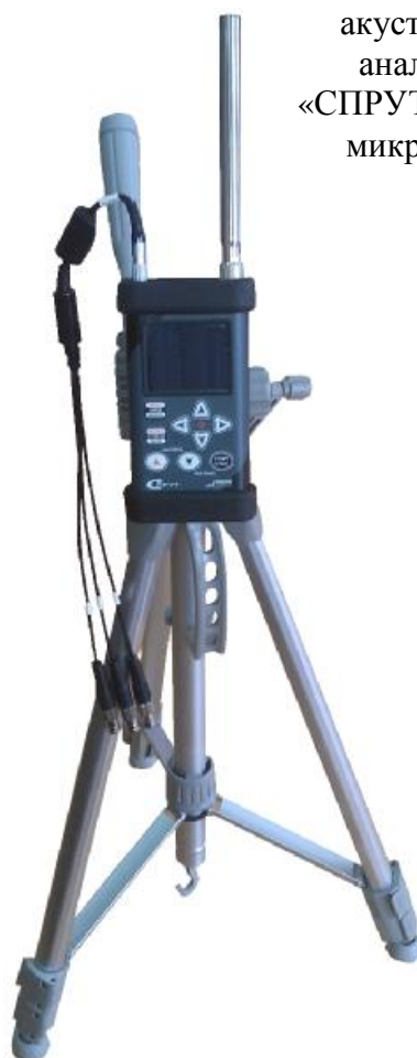
Штатив для установки измерительного модуля
