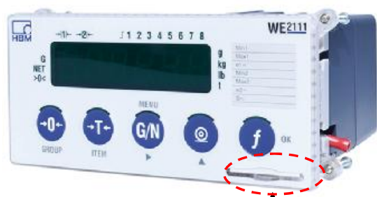
Место пломбировки разрушаемой наклейкой доступа к переключателю режима настройки на передней панели корпуса приборов WE2111
