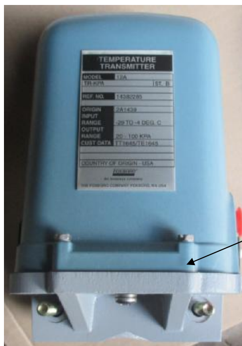
Рисунок 2 - Пломбировка преобразователя температуры пневматического модели 12А
