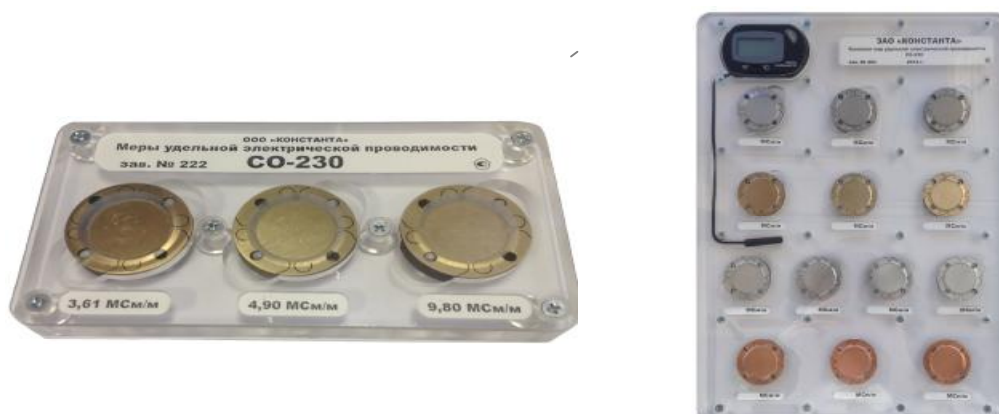
Рисунок 1 - Меры удельной электрической проводимости СО-230
