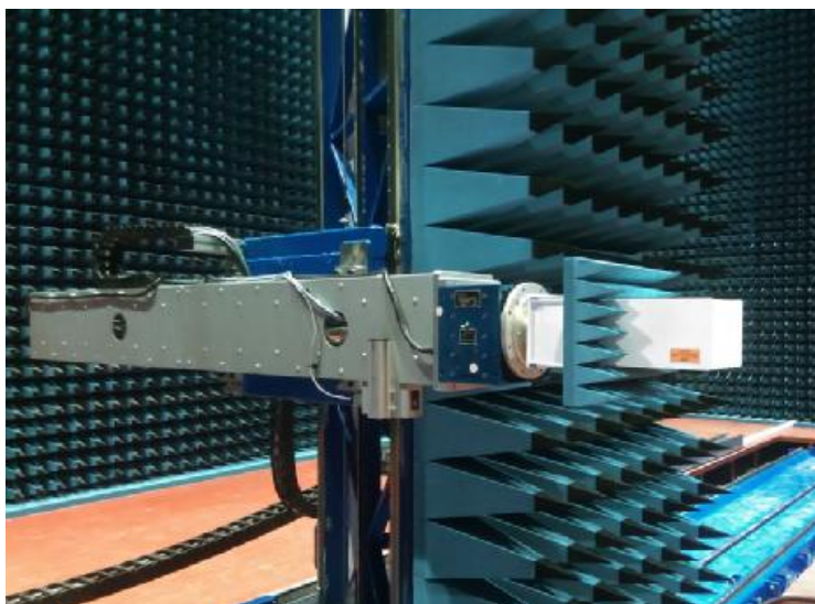
Рисунок 3 – Внешний вид сканера (ось Z) с установленной антенной-зондом
