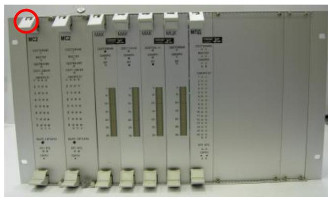
Рисунок 2 – Схема кассетного модуля и место блокировки модуля
