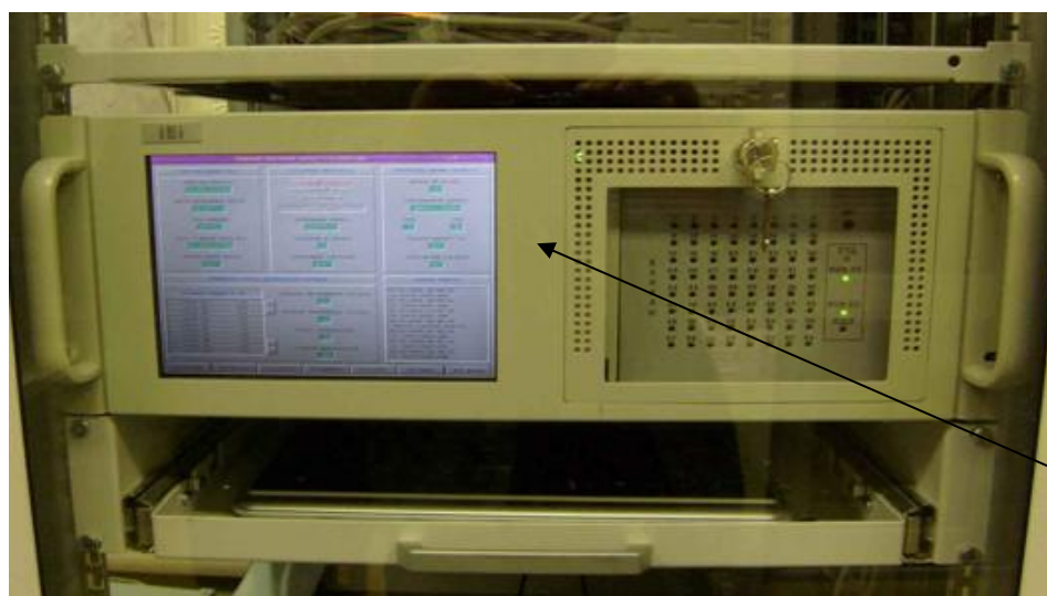
Рисунок 4 - Аппаратура АСН-7/Ш-64 в стойке, вид спереди Примеры схемы пломбировки от несанкционированного доступа приведены на рисунках 2 (вид сзади) и 5. На рис.2 пломба в виде наклейки, закрывающая доступ к монтажному винту. На рис. 5 пломбы в виде наклеек, разрушаемых при открытии. Знак поверки наносится способом галограммы на место, указанное на рис. 4.
