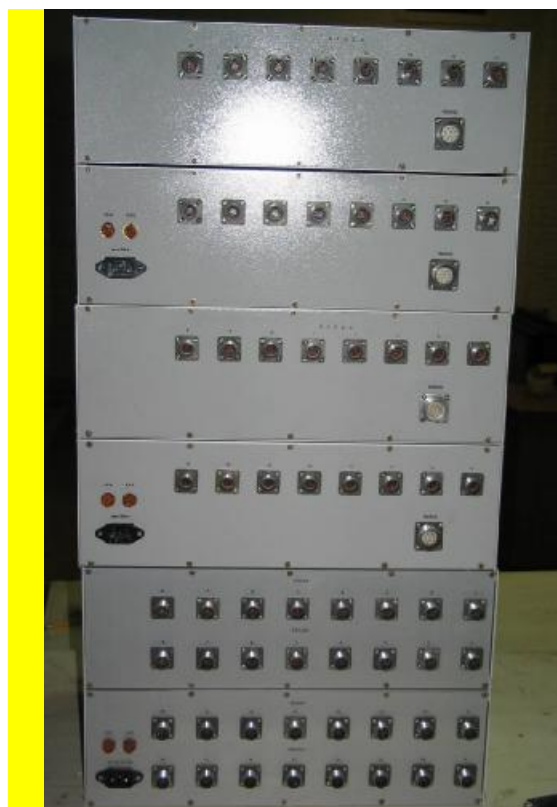
Рисунок 2 - Трехканальный подземный блок телеметрии АСПИ-М/Ш. (Вид спереди и сзади)
