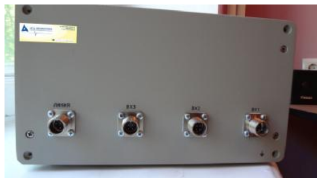
Рисунок 2 - Трехканальный подземный блок телеметрии АСПИ-М/Ш. (Вид спереди и сзади)
