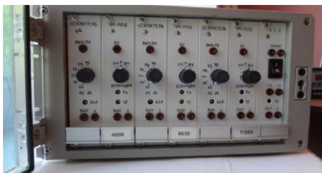
Рисунок 2 - Трехканальный подземный блок телеметрии АСПИ-М/Ш. (Вид спереди и сзади)
