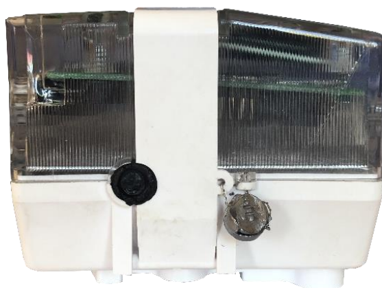
Рисунок 2 – Схема пломбировки от несанкционированного доступа, обозначение места нанесения знака поверки расходомеров УРЖ2КМ Модель 3
