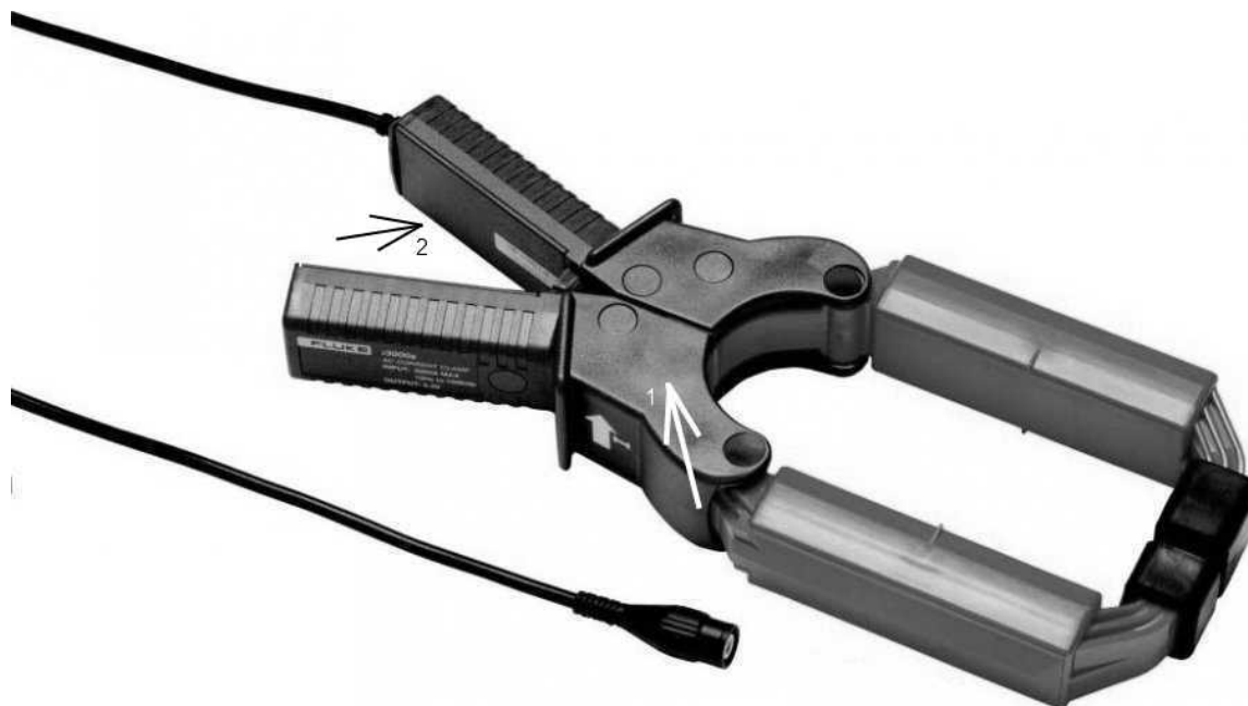
Рисунок 2 - Внешний вид клещей модели Fluke i3000s, стрелкой №1 показано место нанесения знака утверждения типа, стрелкой №2 показано место нанесения поверительного клейма
